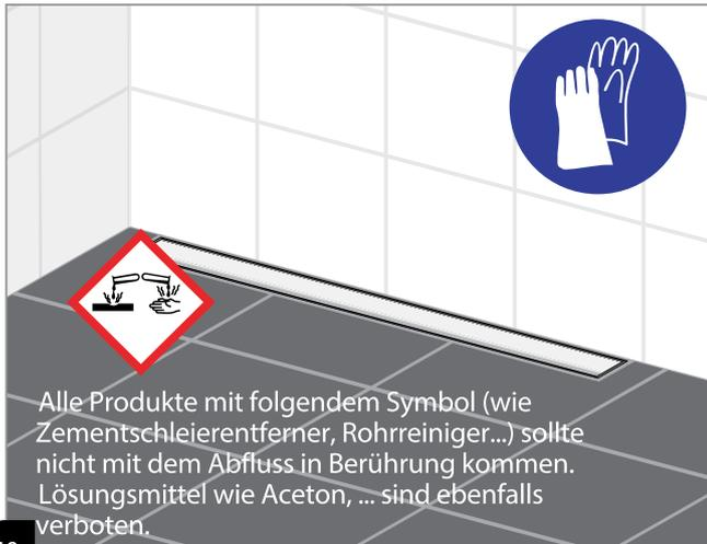
Alle Produkte mit folgendem Symbol (wie Zementschleierentferner, Rohrreiniger...) sollte nicht mit dem Abfluss in Berührung kommen. Lösungsmittel wie Aceton, ... sind ebenfalls verboten.
